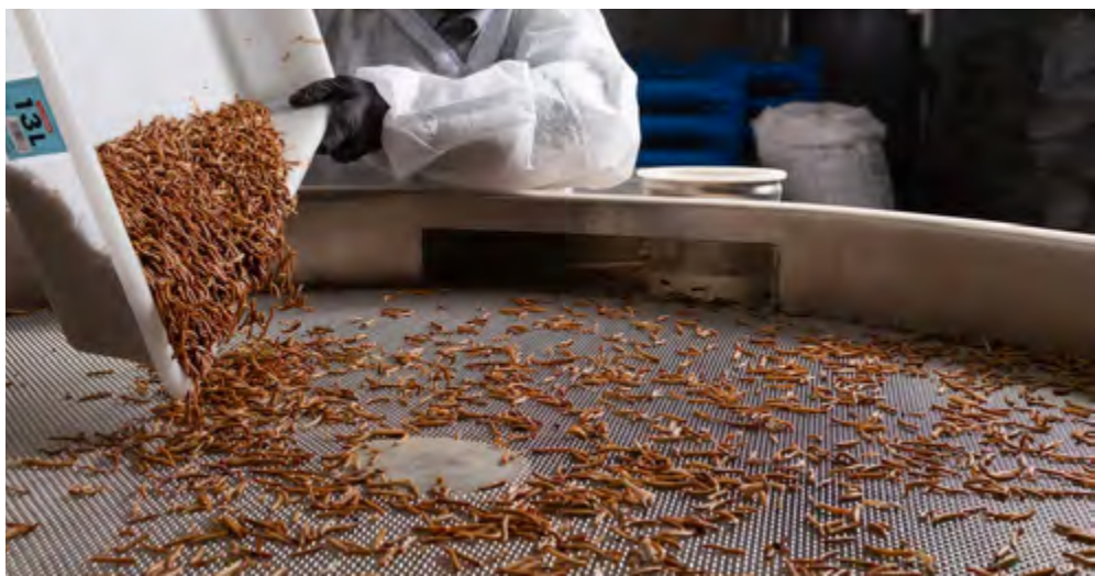
Un operari aboca una safata de larves de Tenebrio molitor en una màquina de processament.
